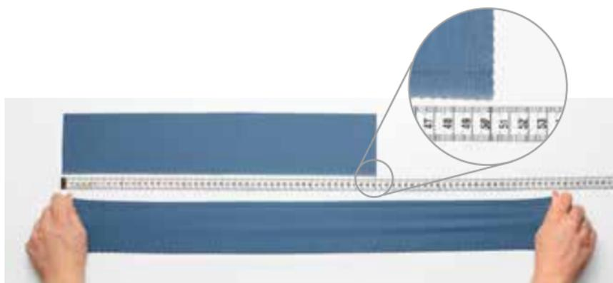
Mit einer Nahtdehnung von bis zu **80%** ist dieser Nähfaden besonders flexibel.
